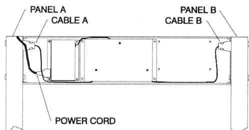
5. Используйте оставшиеся винты и шайбы для присоединения поперечной балки (Crosspiece) к двум панелям, как показано.
