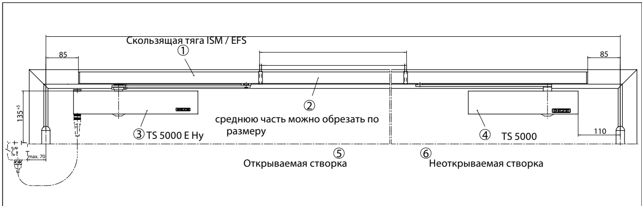
Пример монтажа системы GEZE TS 5000 ISM-EFS на двухстворчатой деревянной двери заподлицо
