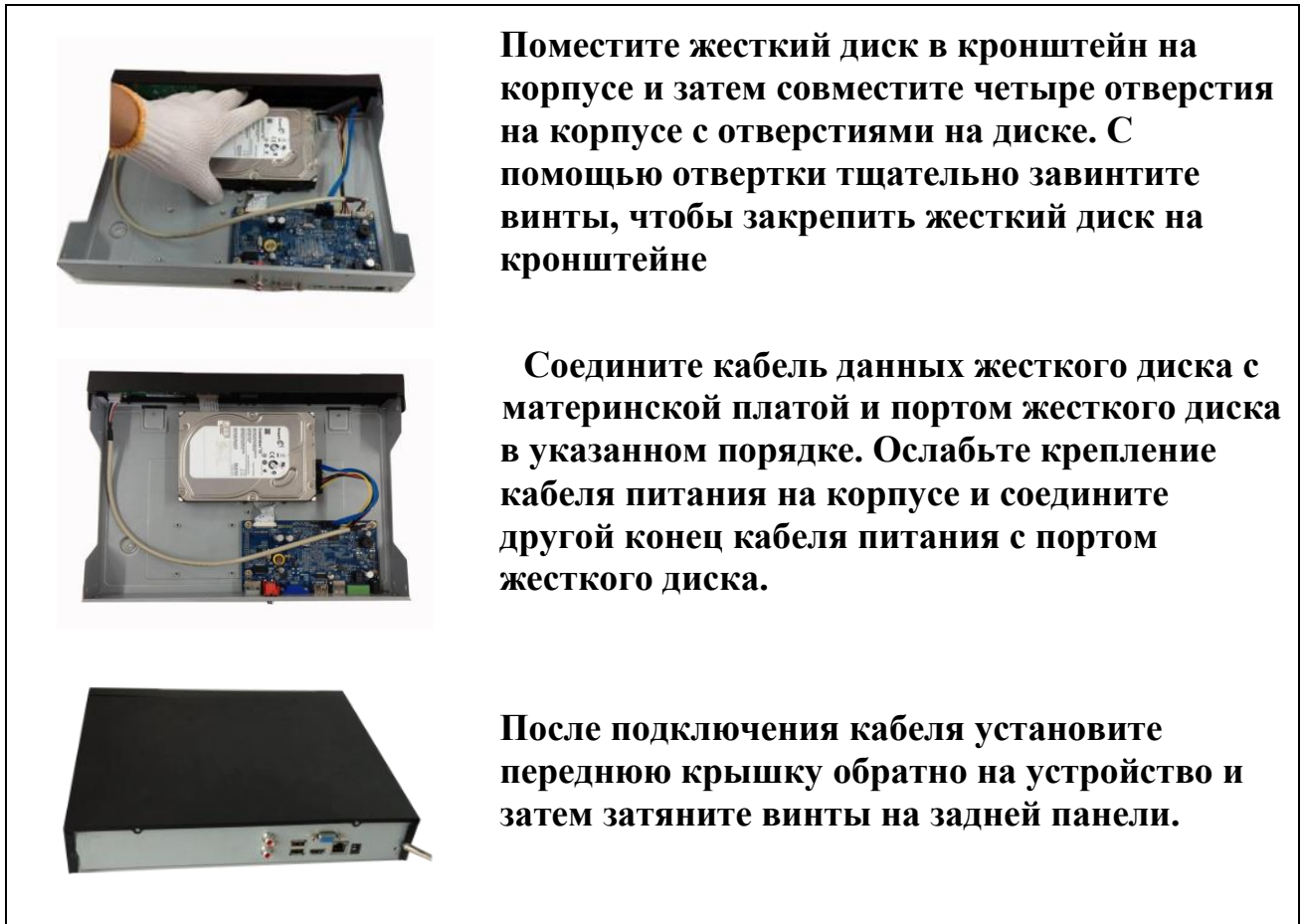
Рисунок 5.1 Установка жесткого диска
