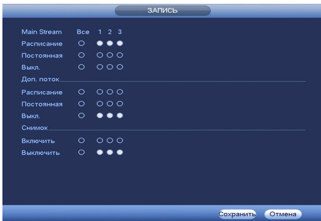
Рисунок 7.30 Интерфейс настройки активации записи.
