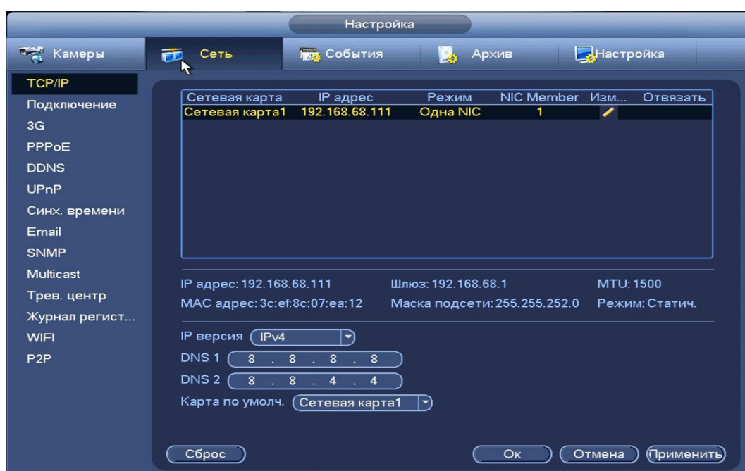
Рисунок 8.50 Интерфейс настройки «ТСР/IP».
