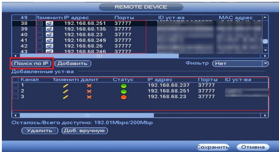
Рисунок 7.32 Настройка добавления камер по поиску в сети.
