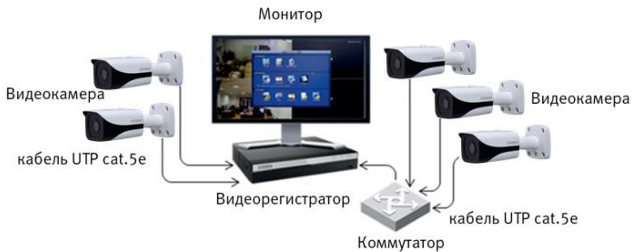
Рисунок 6.4 – Схема подключения видеокамеры к видеорегистратору
