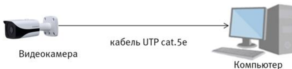
Рисунок 6.2 – Схема подключения видеокамеры к компьютеру
