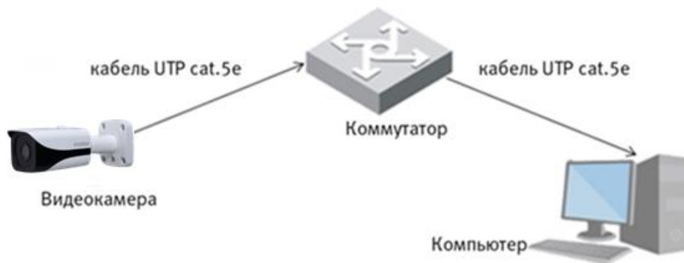
Рисунок 6.3 - Схема подключения видеокамеры к компьютеру через коммутатор
