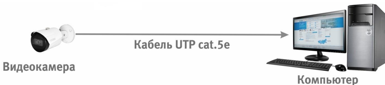
Рисунок 6.2 – Схема подключения видеокамеры к компьютеру
