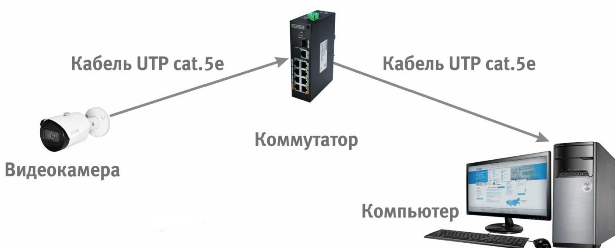
Рисунок 6.3 - Схема подключения видеокамеры к компьютеру через коммутатор
