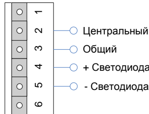
рис. 17. Схема подключения считывателей типа «1-Wire» к клеммам XP2 и/или XP3
