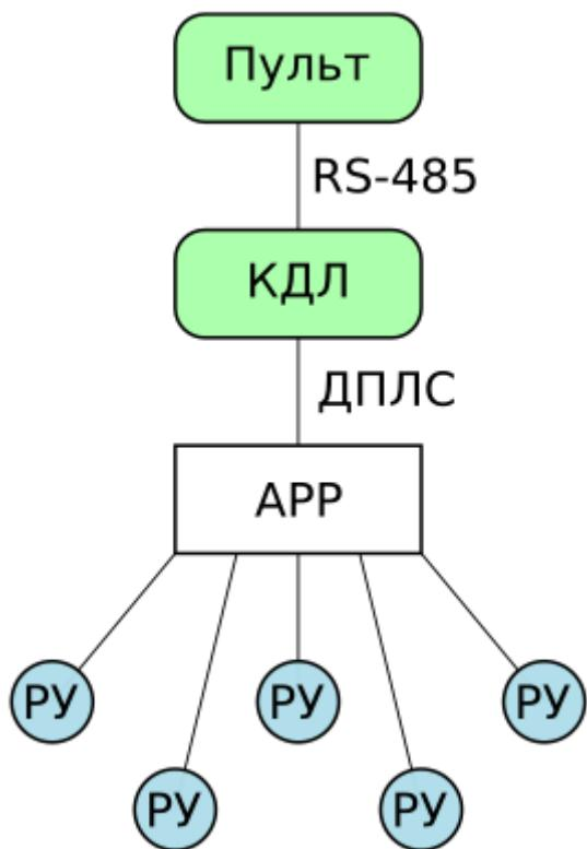
Рисунок 1.1 Блок-схема подключения адресных радиоканальных устройств
