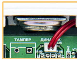
Рита говорит с помощью динамика, который встроен в корпус прибора и подключён к плате.
