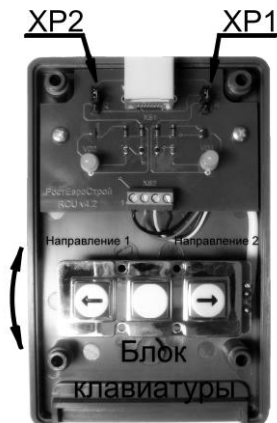
Вид пульта со снятой крышкой
