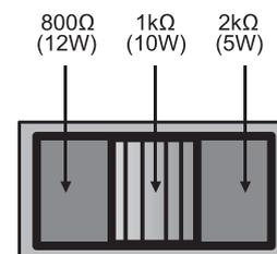
Входной импеданс (подводимая мощность) CS-6/12 определяется положением движкового переключателя.
