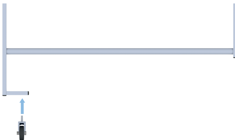
Рисунок 7.2.2 Установка опорного колеса
