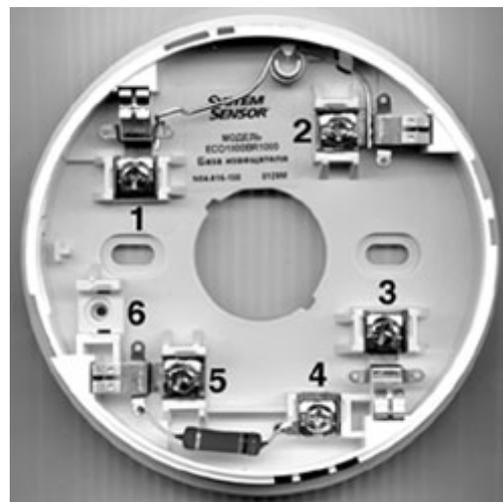
Рис. 1. Расположение контактов базы E1000R
