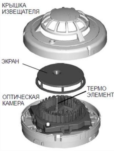
5. При помощи пылесоса и кисточки или струи чистого сухого сжатого воздуха удалите пыль и грязь из оптической камеры и с внутренней части экрана.
