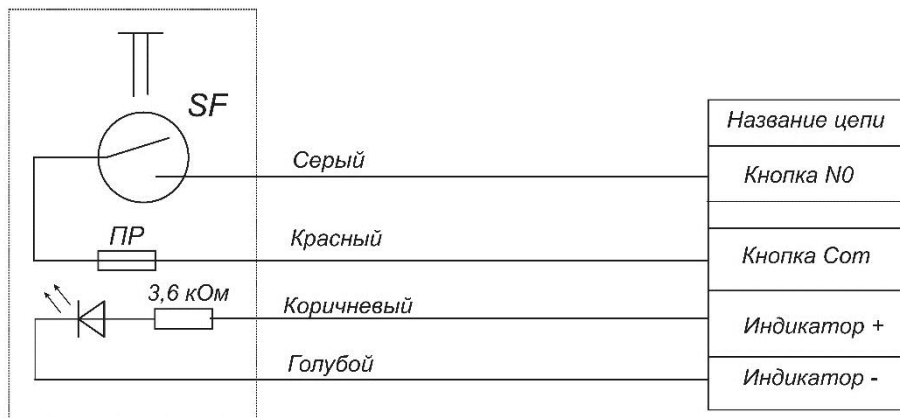
Рисунок 2 – Маркировка выводов изделия AL-BT-S02
