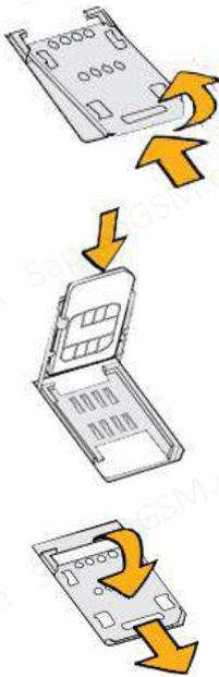
Снимите заднюю крышку, закрывающую отсек для SIM-карты.
