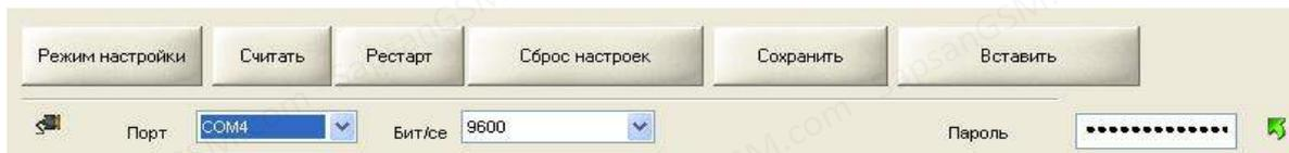
**«Порт»** Выбор порта через который контрольная панель (далее КП) подключена к персональному компьютеру (далее ПК). Посмотреть текущий порт подключения возможно в «ПУСК» -> «Панель управления» -> «Система» -> «Оборудование» -> «Диспетчер устройств» -> «Порты (COM и LPT)»
