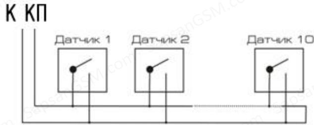
Датчики, имеющие выходной контакт типа «Нормально замкнутый контакт» («NC»), соединяются друг с другом последовательно.
