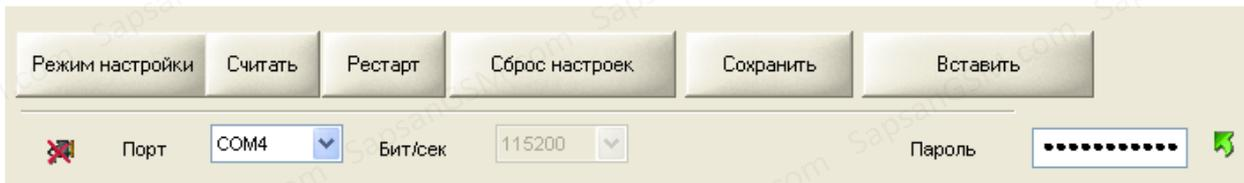
**«Порт»** Выбор порта через который контрольная панель (далее КП) подключена к персональному компьютеру (далее ПК). Посмотреть текущий порт подключения возможно в «ПУСК» -> «Панель управления» -> «Система» -> «Оборудование» -> «Диспетчер устройств» -> «Порты (COM и LPT)»
