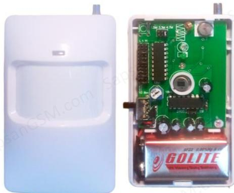
2. Отключить питание датчика (вытащить батарейку, если датчик без выключателя).
