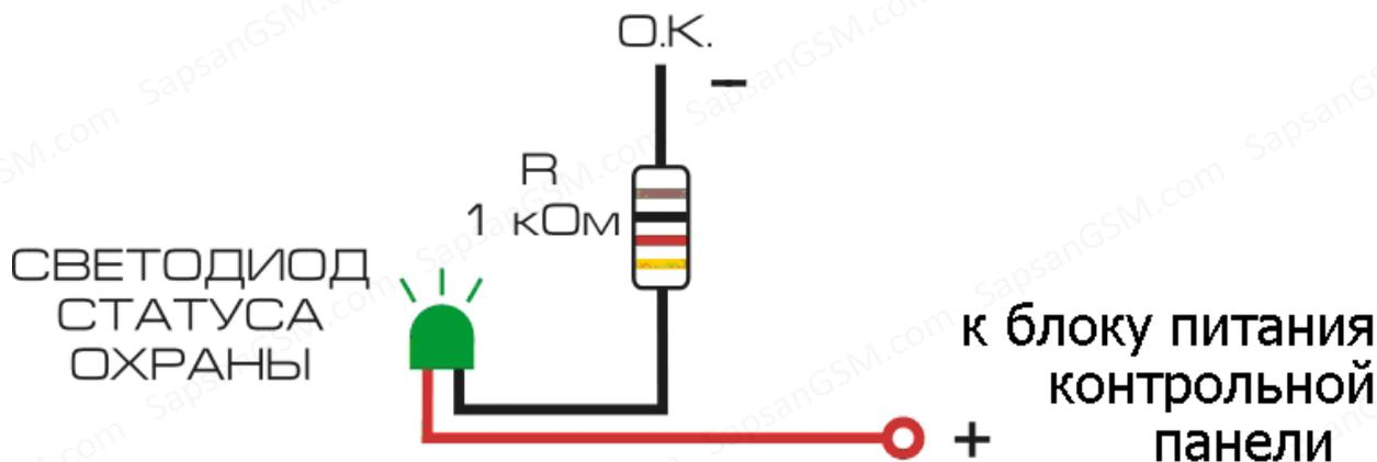
Подключите светодиод (лампу) в соответствии со схемой, представленной выше. При этом соблюдайте полярность.
