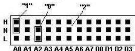
12 рядов переключателей разделены на 2 сектора А0...А7 и D0...D3. Для программирования датчика необходимо выставить переключки в зоне "А" в соответствии с кодом запрограммированным в контрольной панели. В зоне "D" переключки выставляются в соответствии с номером необходимой зоны.
