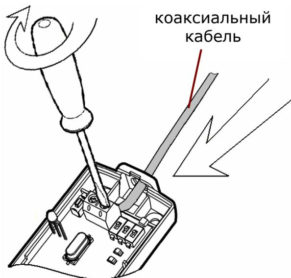
Центральную жилу кабеля следует присоединять к контакту "А", экран кабеля – к контакту "⊥".
