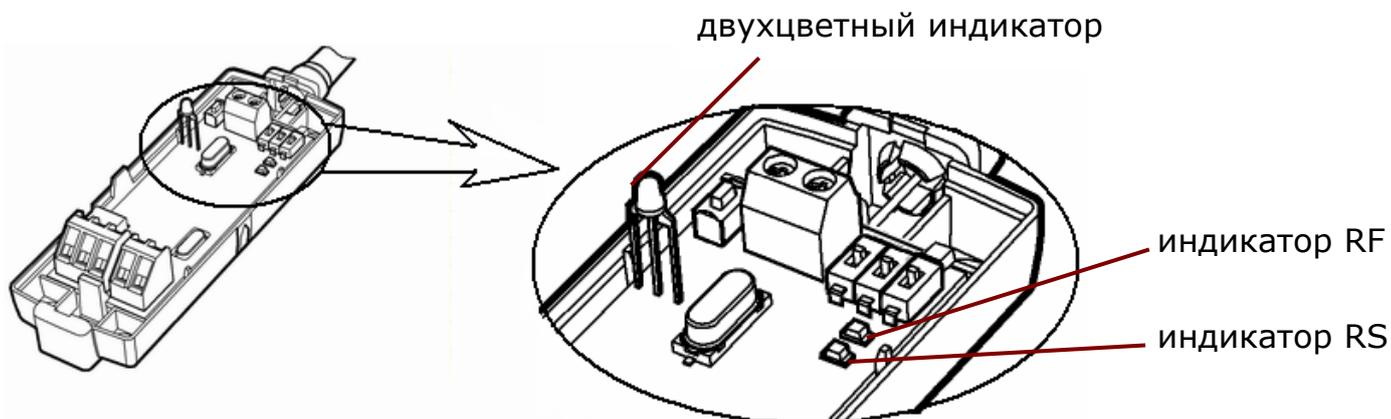
Индикатор "RS" отображает состояние обмена информацией по интерфейсу RS-232/USB с подключенным системным устройством/ПК. Индикатор "RF" отображает состояние обмена информацией по радиоканальному интерфейсу с РРОП. Индикаторы светятся при наличии обмена.
