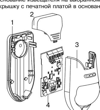
Рисунок 3 – Конструкция извещателя
