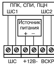
Рисунок 2 – Схема подключения извещателя с отдельными шлейфами сигнализации и вскрытия корпуса
