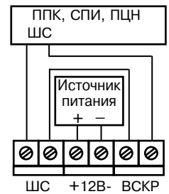
Рисунок 3 – Схема подключения извещателя с объединенными шлейфами сигнализации и вскрытия корпуса
