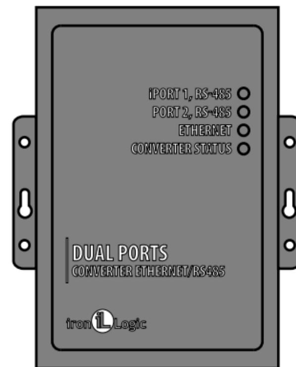
**ETHERNET** - отображает состояние подключения по локальной сети.
