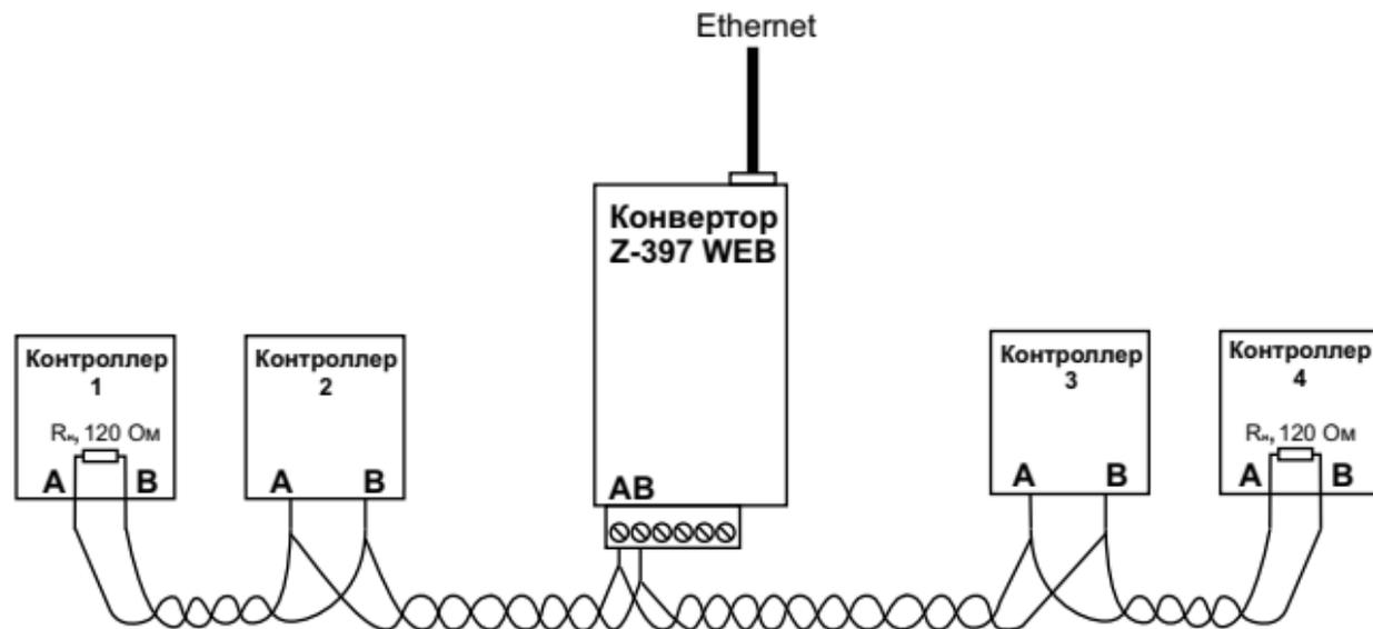
Пример схемы подключения конвертера в середине линии RS-485.
