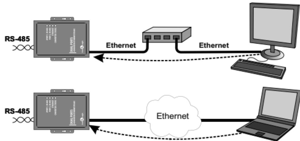
Этот режим удобно использовать, когда известен IP-адрес конвертера или структура и настройки сети позволяют программному обеспечению обнаруживать конвертер. Также преимуществом данного режима является возможность подключения к конвертеру с разных компьютеров как находящихся в локальной сети, так и по сети Internet.
