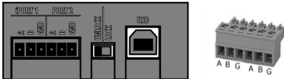
**iPORT1** - разъём для подключения к гальваноразвязанной линии №1 RS-485.
