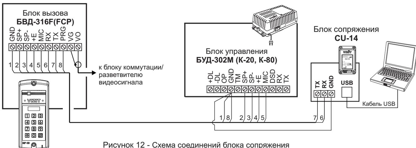
Рисунок 12 - Схема соединений блока сопряжения с блоками управления **БУД-302М (К-20, К-80)**
