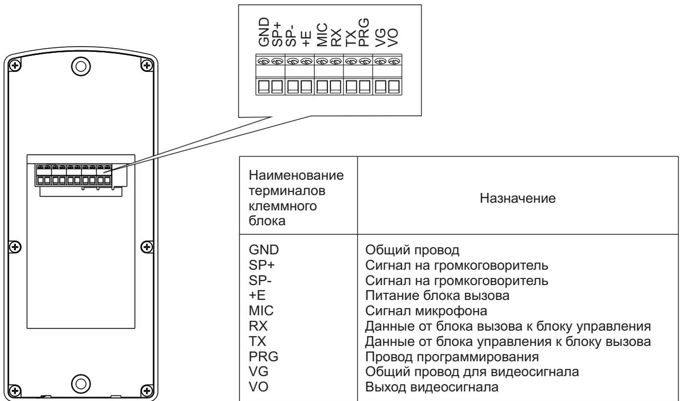
Рисунок 5 - Расположение и назначение клемм блока вызова
