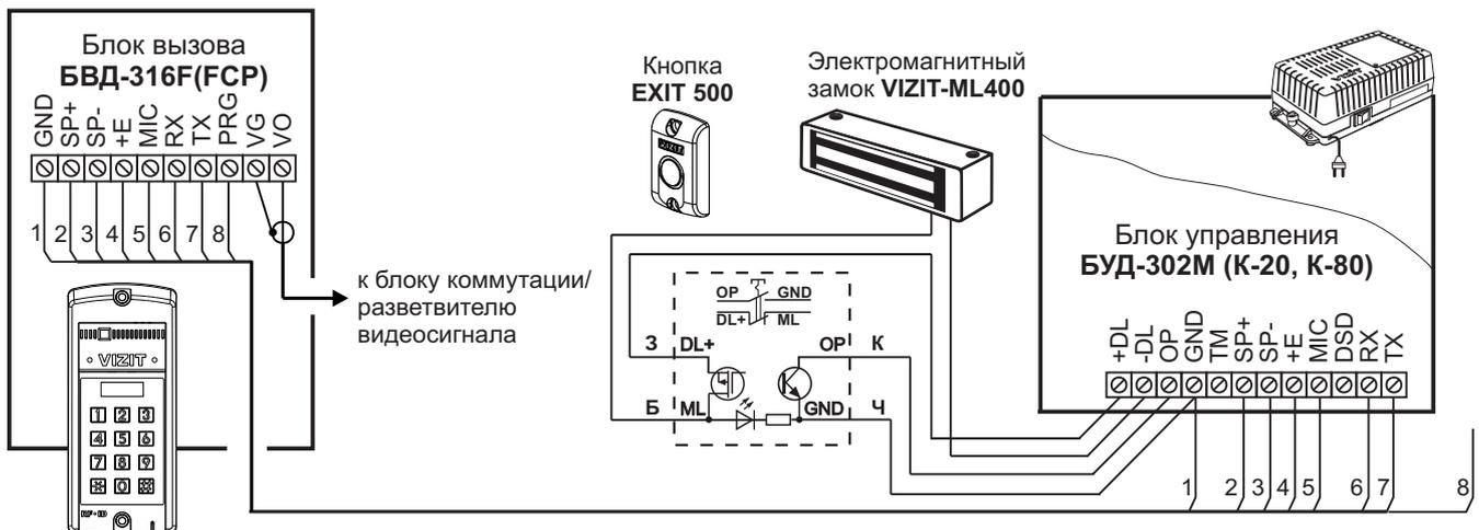
Рисунок 7 - Схема соединений блока вызова БВД-316F(FCP) с блоком управления БУД-302М (К-20, К-80), электромагнитным замком VIZIT-ML400 и кнопкой EXIT 500
