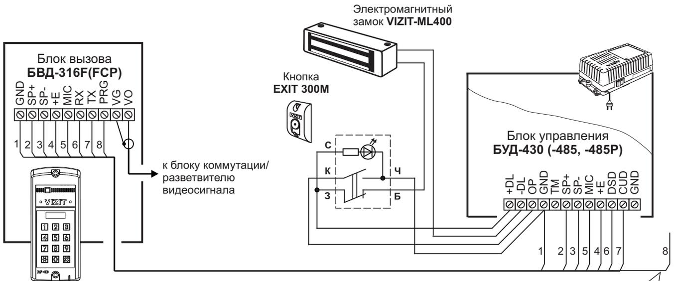
**Примечание.** Подключите провод PRG к клемме GND блока управления при записи МАСТЕР-ключа №1. Отключите провод PRG после окончания записи МАСТЕР-ключа №1.
