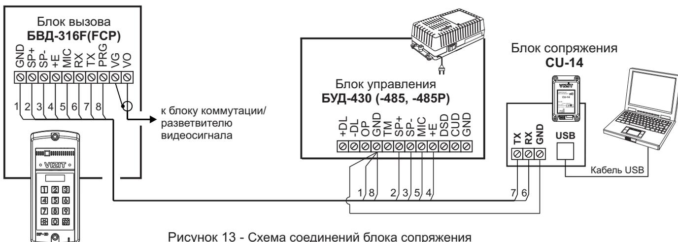
Рисунок 13 - Схема соединений блока сопряжения с блоками управления **БУД-430 (-485, -485P)**
