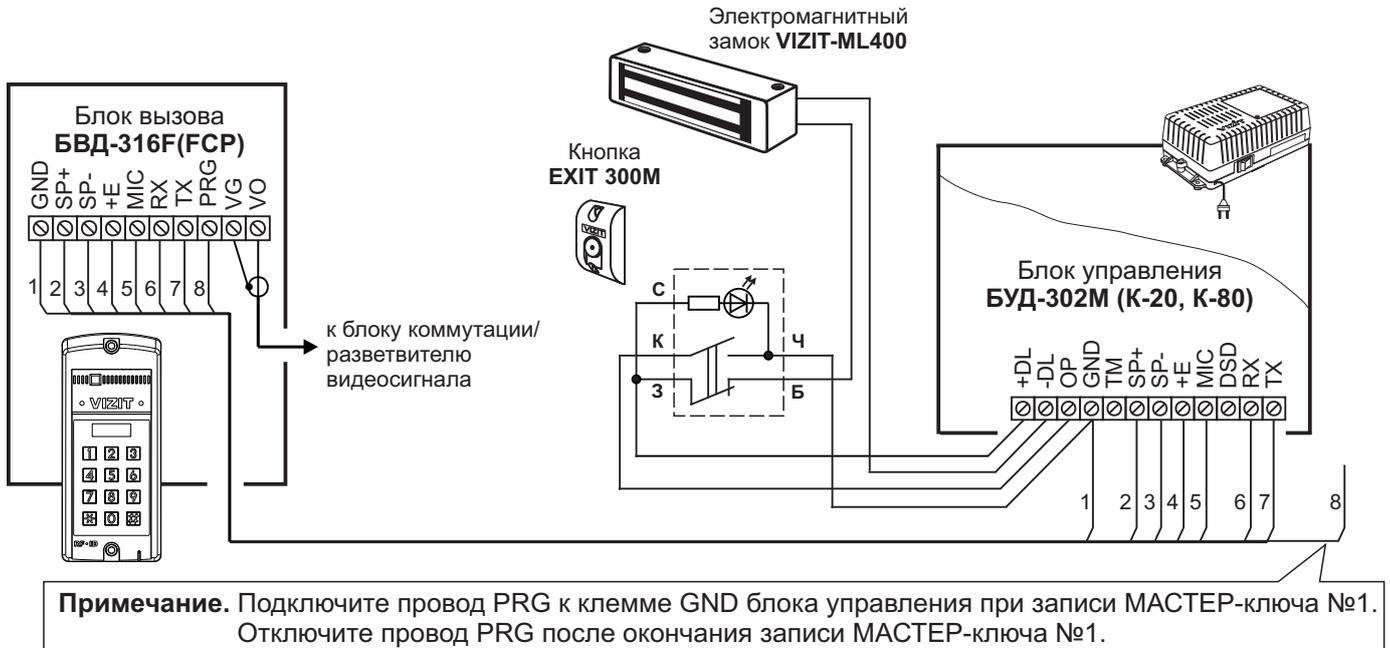
Рисунок 6 - Схема соединений блока вызова БВД-316F(FCP) с блоком управления БУД-302М (К-20, К-80), электромагнитным замком VIZIT-ML400 и кнопкой EXIT 300M
