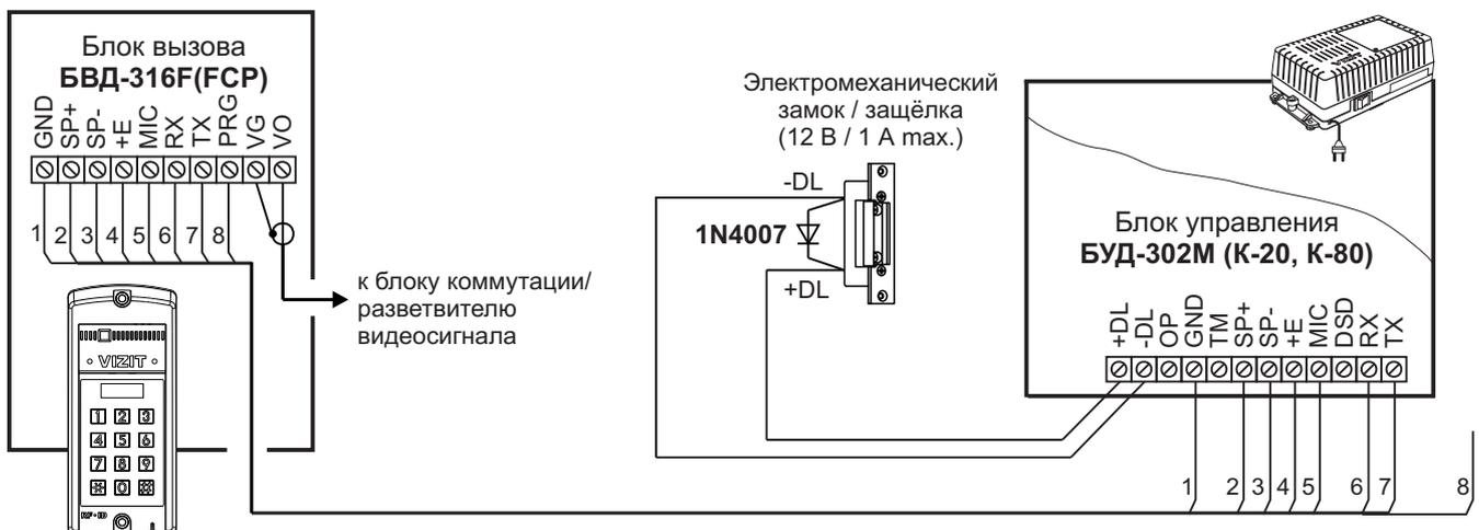
Если электромеханический замок / защёлка не содержат встроенный защитный диод, то между клеммами замка / защёлки следует установить диод, как показано на схеме
