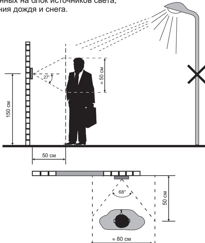
Рисунок 4 - Рекомендуемая высота установки блока вызова и область обзора телекамеры
