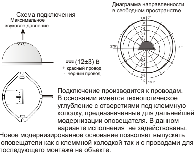
Рис.2 Схема подключения и диаграмма направленности оповещателя.
