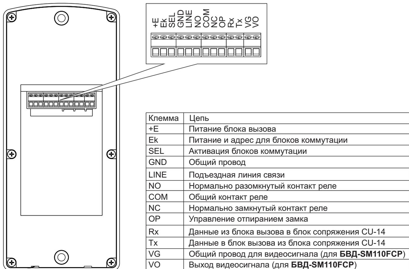
Рисунок 5 - Расположение и назначение клемм блока вызова
