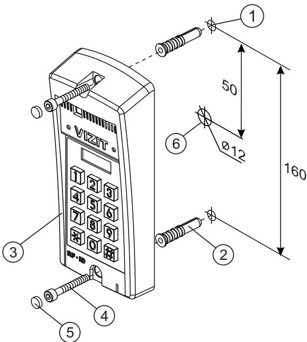
1. Отверстие (x2) диаметром 8 мм, глубиной 40 мм
