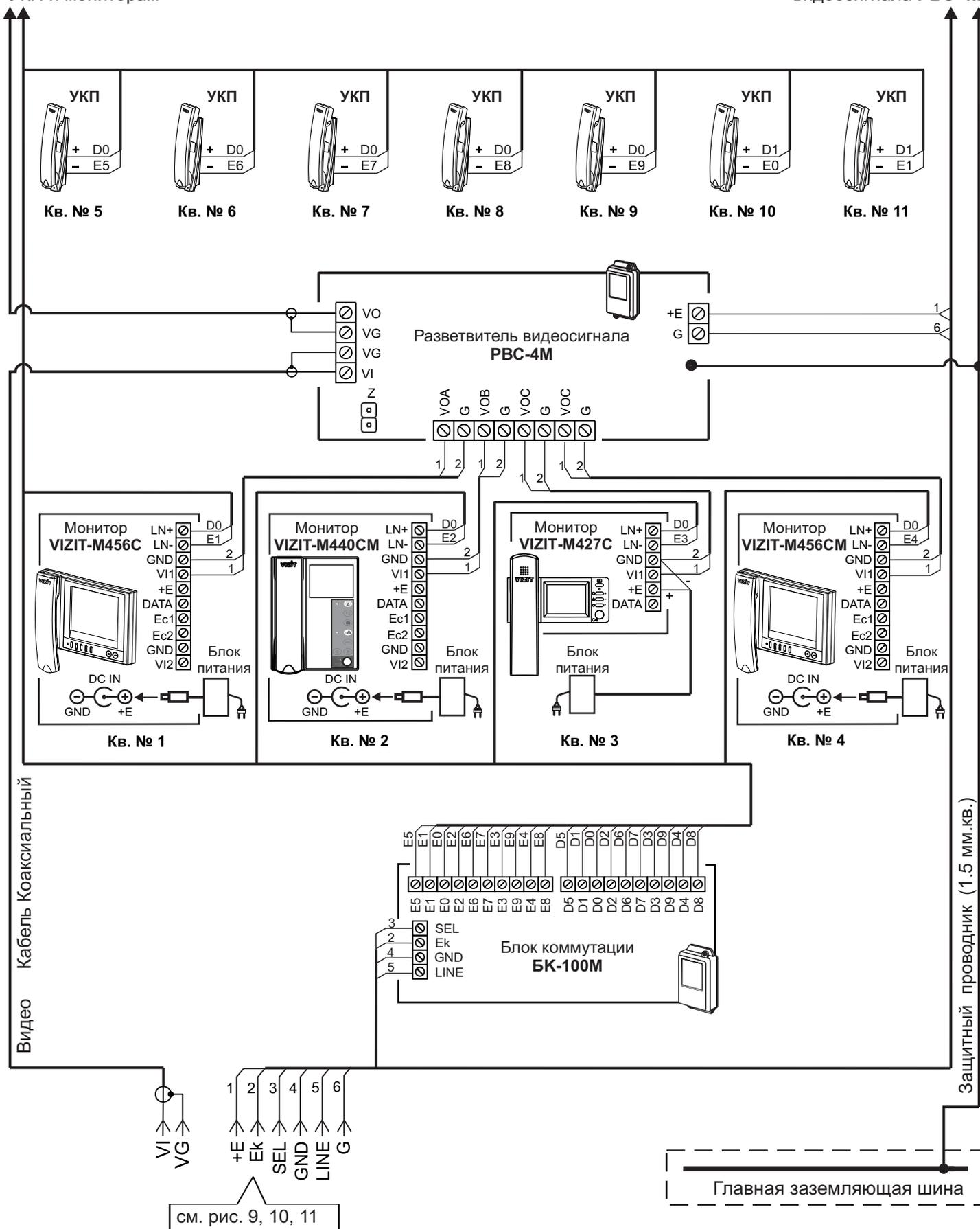
Рисунок 19 - Схема соединений блока вызова **БВД-SM110FCP** с блоком коммутации **БК-100М**, разветвителями видеосигнала **PBC-4M** и мониторами **VIZIT** в составе многоабонентского видеодомофона до 100 абонентов
