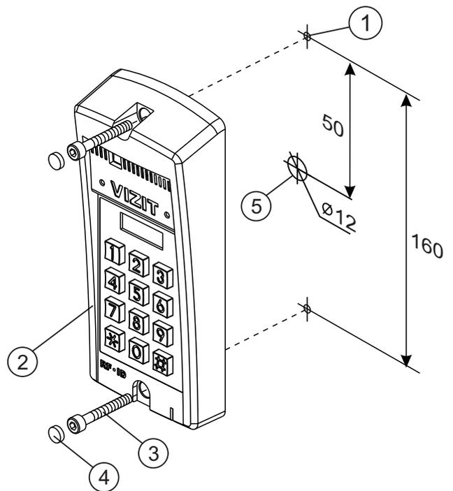
1. Отверстие (x2) диаметром 4,2 мм
