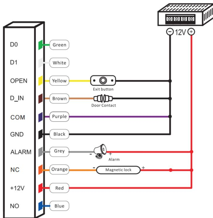
Подключение в качестве считывателя:
